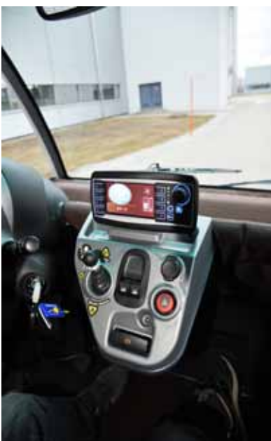
La console centrale regroupe l'essentiel y compris les interrupteurs des vitres électriques
