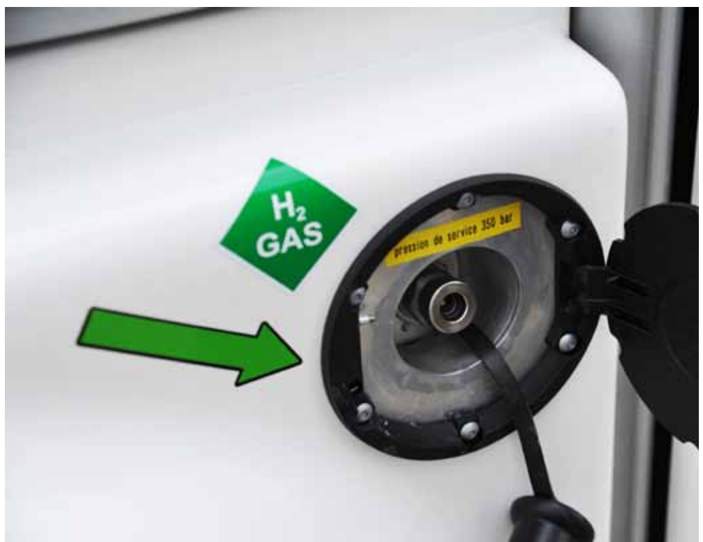
L'orifice de remplissage spécifique à l'hydrogène gazeux sous pression, ici maximum 350 bars
