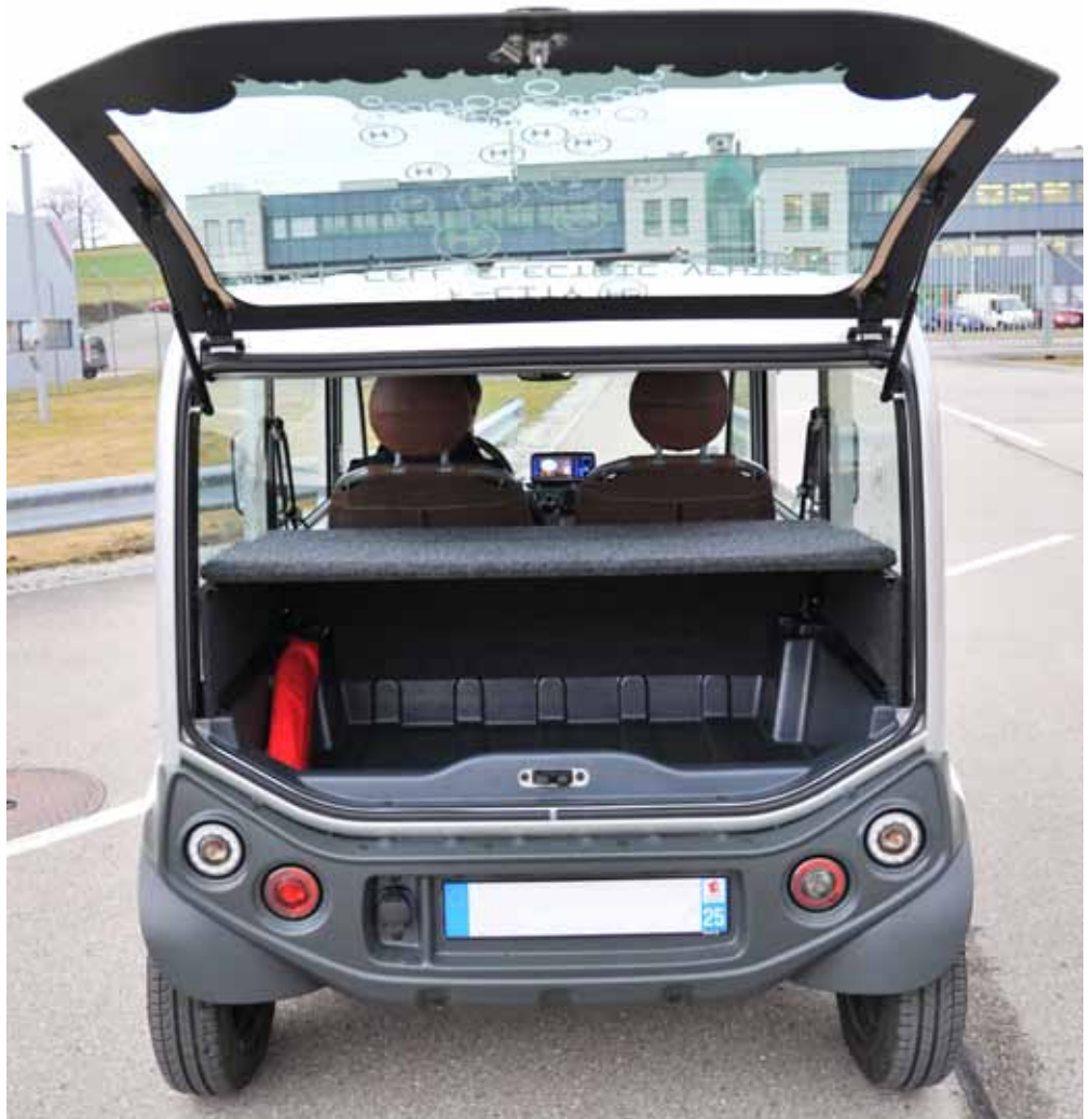
Le coffre arrière, en thermoplastique, permet d'emporter quelques bagages pour un court voyage
