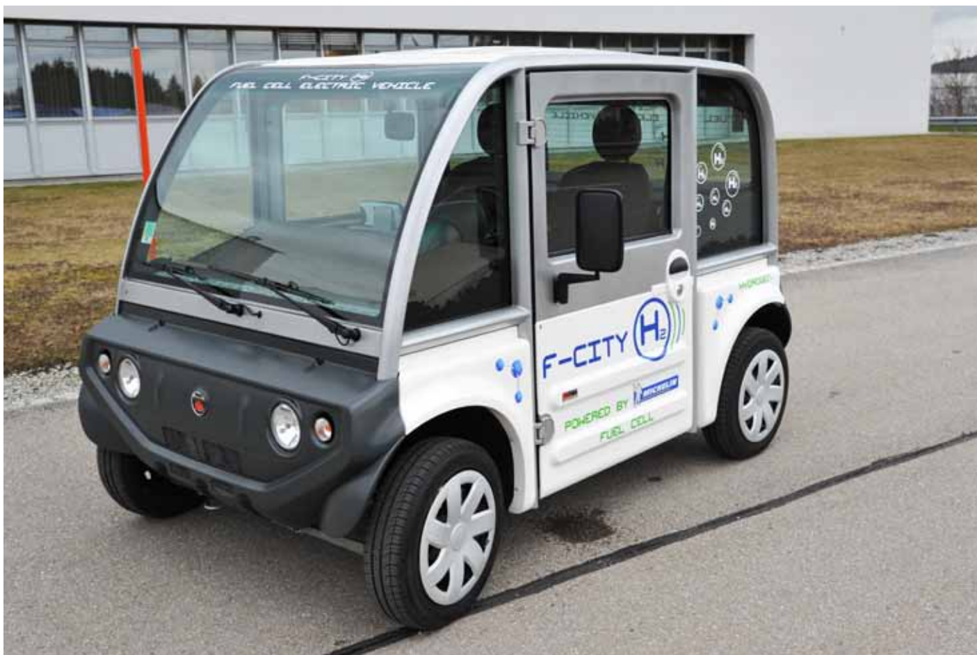
FAM F-City H2, le véhicule urbain à pile à combustible à hydrogène
