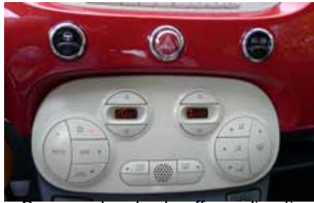
Commandes de chauffage-climatisation
