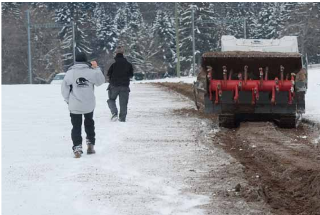
500 m 2 à l'heure, le terrain est réduit en bouillie et donc sécurisé
