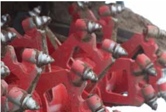
Détail des «dents» en carbure de tungstène
