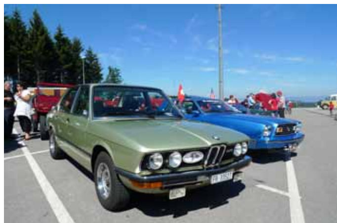
La plus récente, BMW 525, 6 cylindres en ligne, 2'494 cm 3 , 150 chevaux, carbu double corps, boîte 4 rapports
