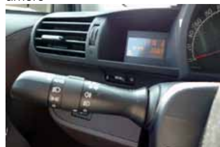
La remise à zéro du partiel est caché par le commodo des phares
