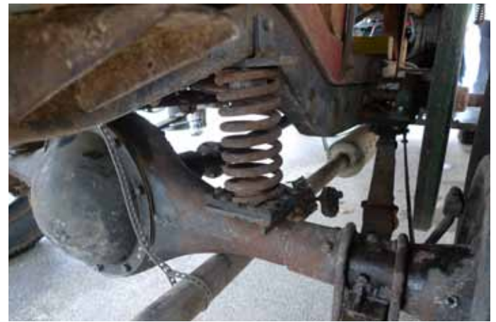
Les dessous de Grand Mère La Scie, pont arrière, ressorts et lames
