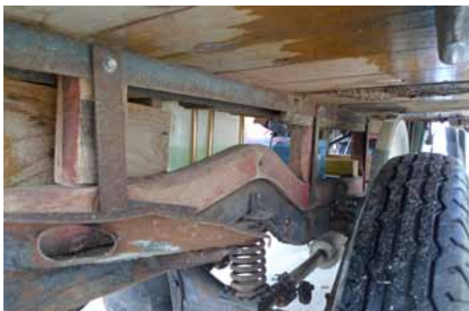
Double châssis fer et bois. Le support du plateau est un ajout pour supporter le moteur et la scie
