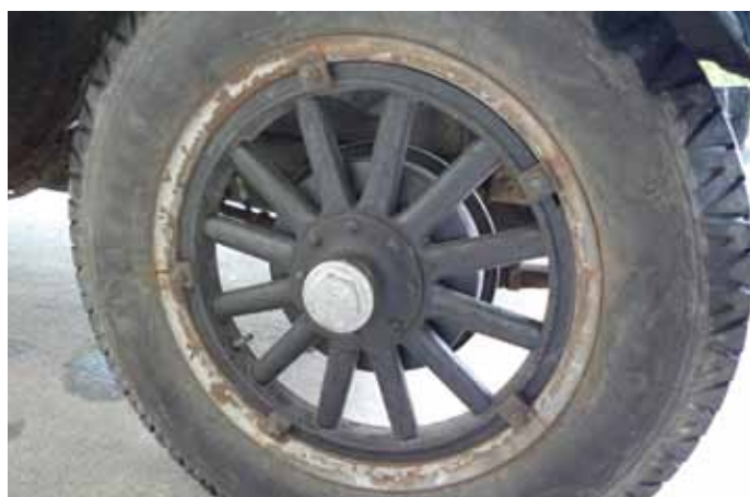
Les roues à rayons en bois. La jante et le pneu sont fixés par des boulons
