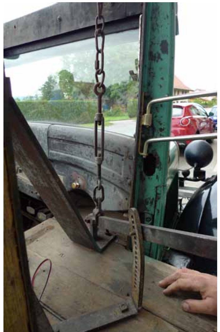
Double châssis fer et bois. Le support du plateau est un ajout pour supporter le moteur et la scie
