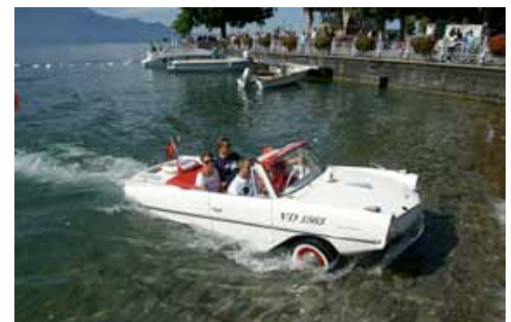
Passage de l'eau à la terre ferme. 12 km/h sur l'eau et 112 km/h sur route
