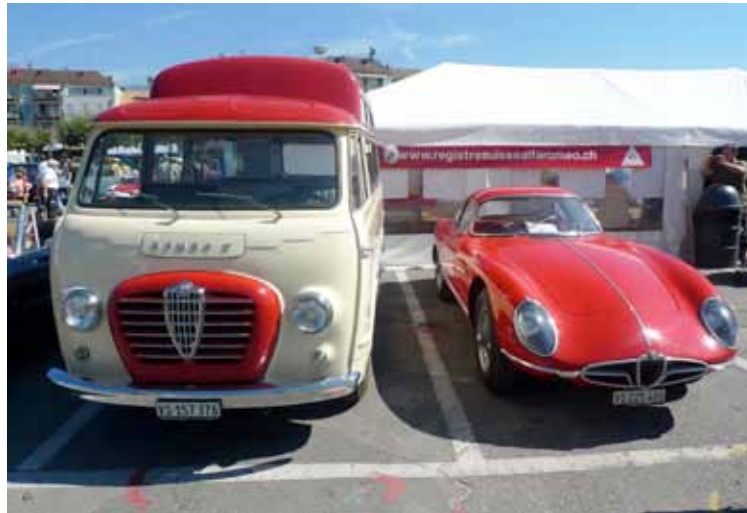
Fourgon Roméo 2 1947. Traction avant. 1290 cm 3 . 80 CV. Carrosserie Colli. Plus de 21'000 exemplaires
