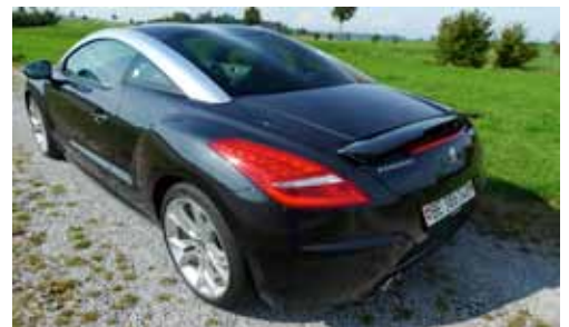
Aileron électrique asservi à la vitesse. Petite touche agressive sur la RCZ
