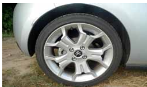
Jante de 17 pouces et pneus en 205 / 45 R 17 pour la ds3
