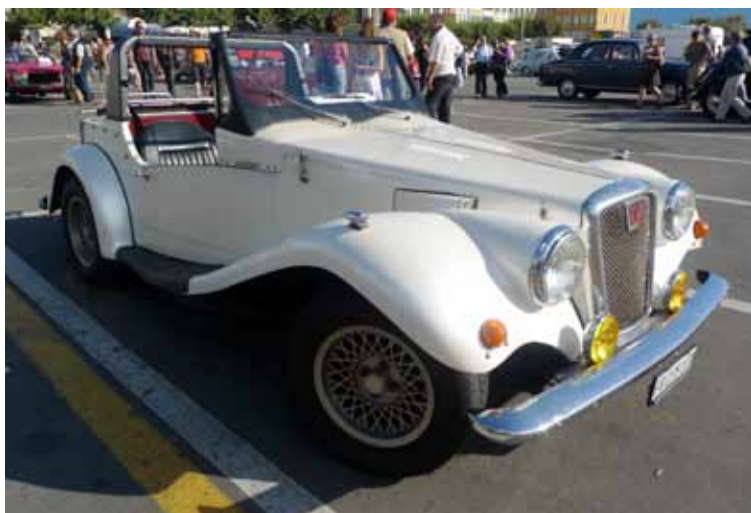
Connaissez-vous Spartan ? En fait, il s'agit d'un modèle de Triumph conçu par Jim McIntyre. La base est une Herald ou une Vitesse. Le kit est commercialisé à partir de 1973
