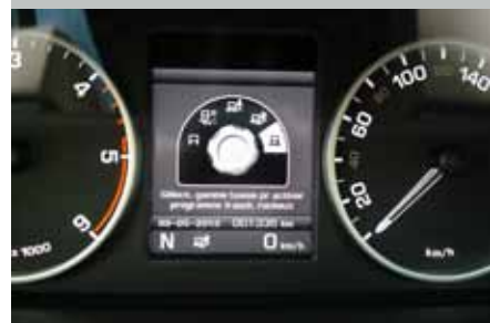
Affichage digital pour la position du rhéostat "Terrain Response"
