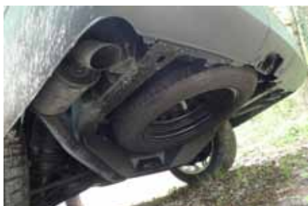
De la porte arrière, la roue de secours est sous le plancher
