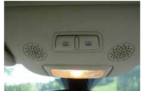
Les commandes de la capote électrique
