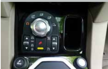
La commande du "Terrain Response" se trouve en avant du levier
