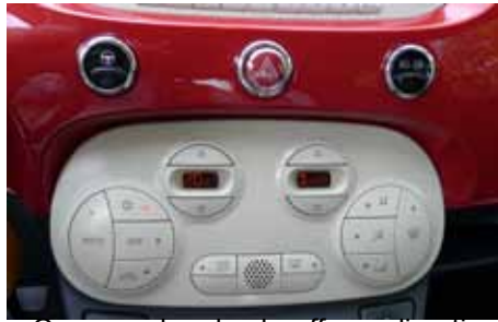
Commandes de chauffage-climatisation
