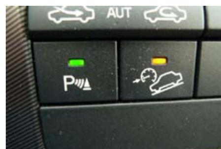
A droite du radar arrière, l'interrupteur de mise en marche de contrôle de descente
