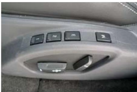
Le siège avant conducteur à mémoire est réglable électriquement. Celui du passager est manuel
