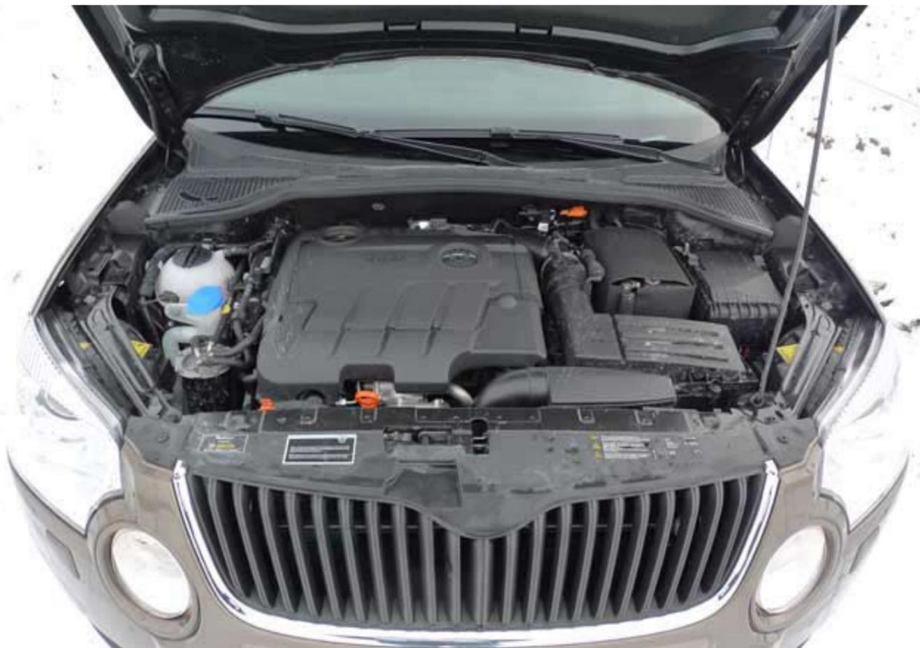
Le Moteur de 2.0 L TDI développe 170 chevaux à 4200 tr/mn pour un couple de 350 Nm entre 1750 et 2500 tr/mn. Il possède une souplesse d'utilisation indéniable. Sa consommation reste dans les domaines du raisonnable avec un minimum à 6,4 l et un maximum à 11 l dans des conditions de circulation normale. La boîte à 6 rapports est bien étagée et complète l'agrément du moteur. Le Yéti est un marathonien pas un sprinter. Toutefois, il est capable de réagir pour des dépassements courts
