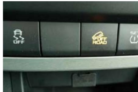
L'interrupteur "Off Road" ne met pas en fonction une boîte de réduction mais le contrôle de descente
