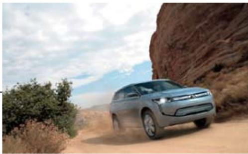
Le concept car PX-MiEV dispose d'un thermique développant 115 chevaux et deux électriques d'une puissance de 40 chevaux chacun
