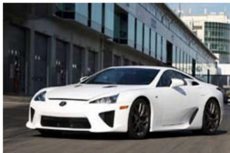
la LF-A animée par un moteur de 4.8 L essence V10 de 560 chevaux et munie d'une boîte séquentielle robotisée à 6 rapports. La transmission se fait aux roues arrière.
