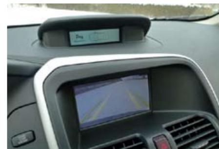
L'écran de la navigation sert pour la caméra de recul. au dessus l'affiche déporté pour la radio et les réglages du véhicule - en allemand et non modifiable par configuration directe
