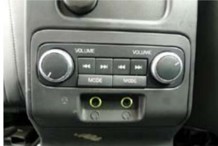
Les passagers arrière disposent d'un accès à la radio par le biais des deux prises jack et des potentiomètres de réglage
